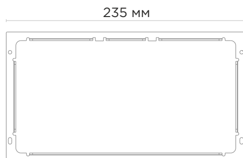
Кронштейн для врезного монтажа
